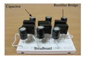
(d) The Electronic circuit converts AC current to DC current
